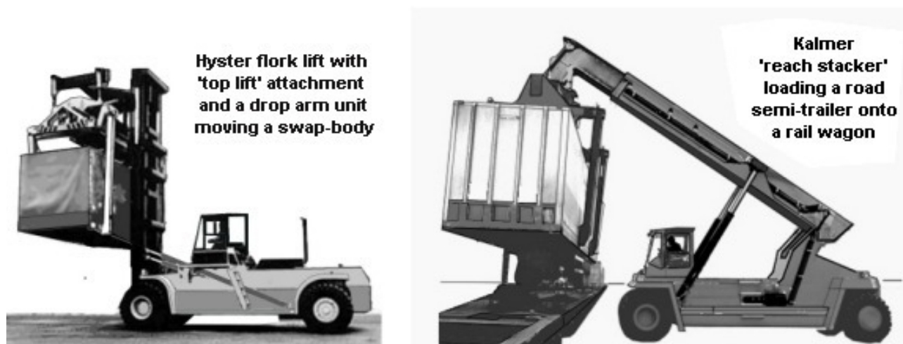
Рис. 1. Вилочный автопогрузчик и кран-штабелер, оснащенные сменным кузовом
